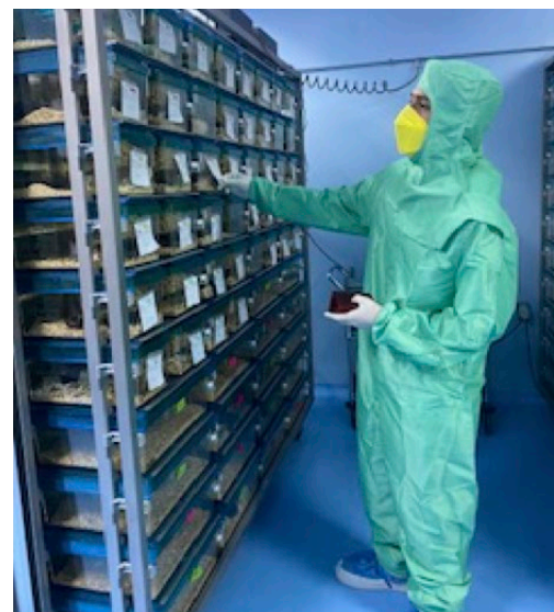
Imagen UPEAL 7. Llegada de equipo con tecnología de punta; Rack ventilado Super Mouse Labproducts que filtra el aire (HEPA) 70 veces por hora con independencia de cada jaula.
